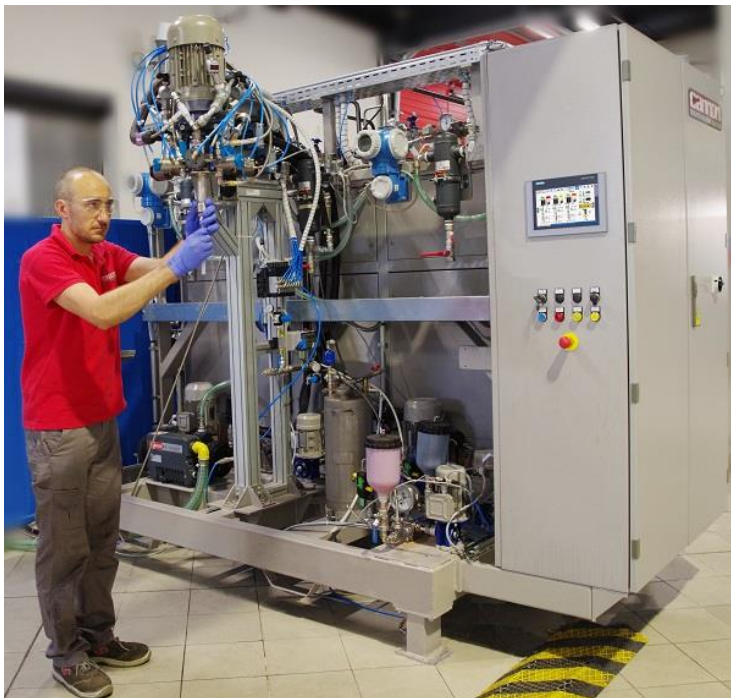
Neue Cannon B-CAST Niederdruck-Dosieranlage mit integrierter Entgasung erweitert die Vorteile von PU-Elastomeren mit geringer Dichte auf wachsende Marktsegmente. Fotos: Cannon Group
